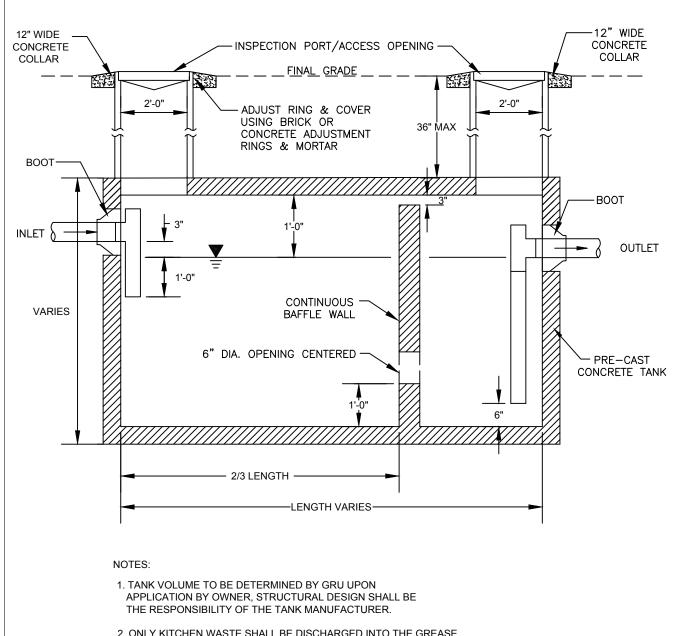
2. ONLY KITCHEN WASTE SHALL BE DISCHARGED INTO THE GREASE TRAP. ALL DOMESTIC WASTE (i.e. RESTROOMS) SHALL BE
